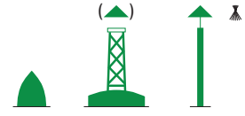
Steuerbordseite Fahrwasser (von See kommend)
